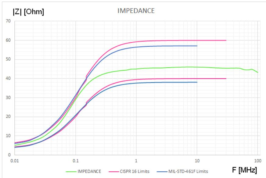
Picture 2: LISN impedance, 50 $\Omega$  // 50 $\mu$ H + 5 $\Omega$
