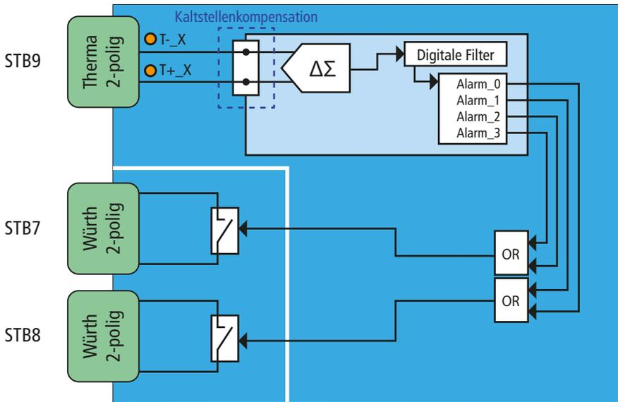
Abb. 8: Blockschaltbild Temperaturmesskanal inkl. Alarm-Relais
