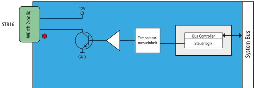
Abb. 12: Blockschaltbild Lüftersteuerung
