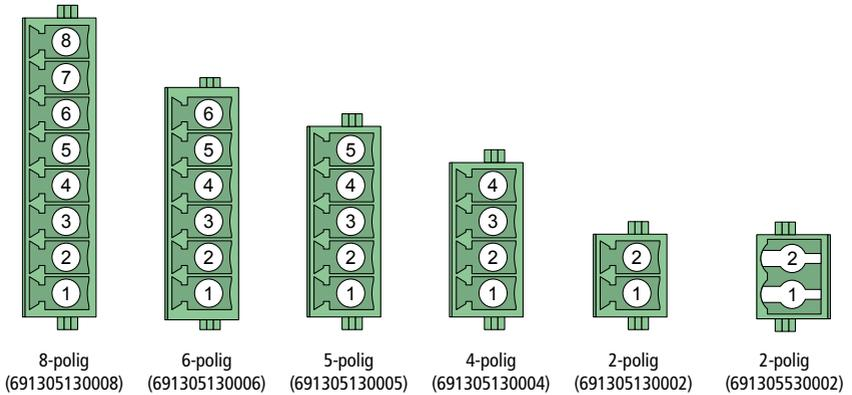
Abb. 18: Würth-Grundleiste Typ WR-TBL 3051 (Draufsicht)
