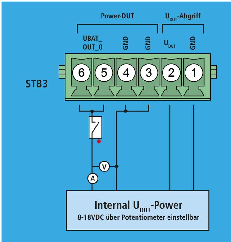
Abb. 7: Blockschaltbild Powermesskanäle
