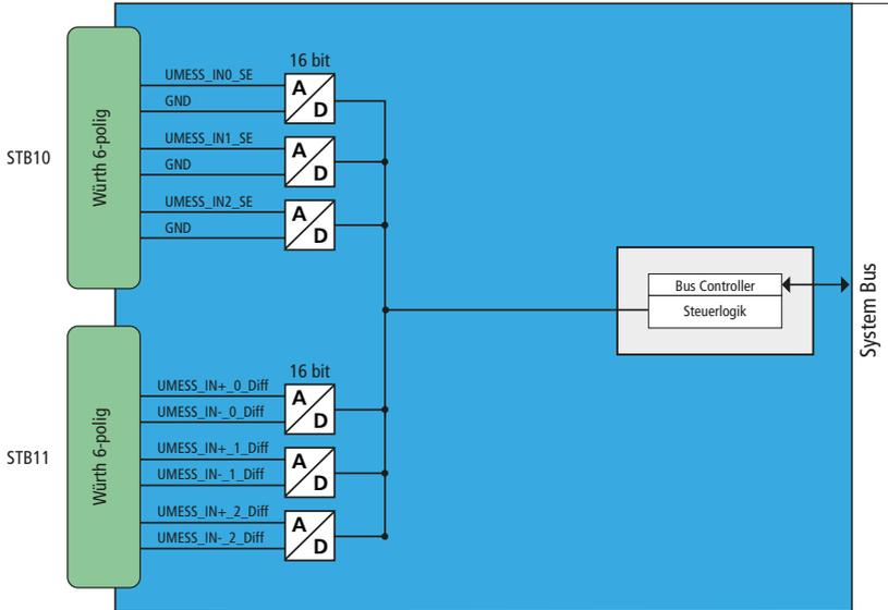
Abb. 11: Blockschaubild analoge Eingänge
