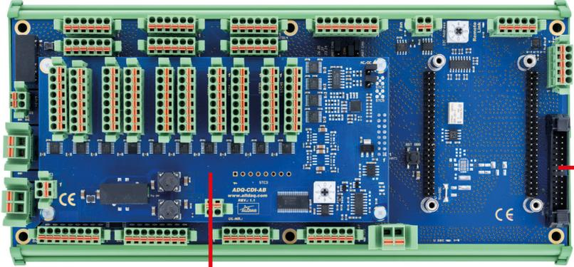
Abb. 13: Position Erweiterungsplatten (HATs)
